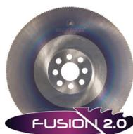
由于带有耐磨损、耐高温,高硬度以及低摩擦系数的多层PVD涂层, Fusion 2.0 可在严苛的应用环境下锯切中、高拉伸强度的碳钢。
