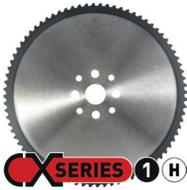
采用了最新的基体设计、新的齿型和新型的PVD涂层, CX1H锯片以极高的生产率锯切高拉伸强度碳钢(>900 N/mm<sup>2</sup>,含碳量≥0.60%)。它也非常适合锯切直径大于35 mm的铁素体、马氏体和双列不锈钢棒。
