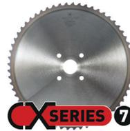
CX7是一种金属陶瓷刀头带有PVD涂层的锯片,专用于锯切中等、低拉伸强度为750 N/mm<sup>2</sup>碳钢(含碳量<0.60%)。锯切较低拉伸强度的材料时,锯片有最佳的使用寿命表现。在许多应用中,可实现50 m<sup>2</sup>及以上的锯片寿命。
